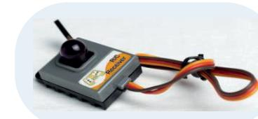
Receptor Infravermelho: Usado para receber comandos do controle remoto.
