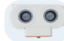
Sensor Ultrassônico: Usado para identificar a distância de objetos em relação ao sensor.
