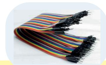
Cabos de Conexão Macho/Macho:
