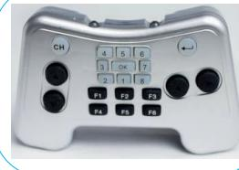
Controle Remoto: Usado para enviar comandos a Placa Controladora através do Receptor Infravermelho.
