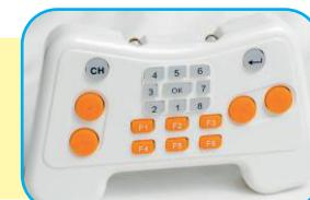
Controle Remoto: Usado para enviar comandos a Placa Controladora através do Receptor Infravermelho.
