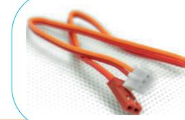
Cabo de Motor DC: Cabo que passa energia para o Motor DC funcionar.
