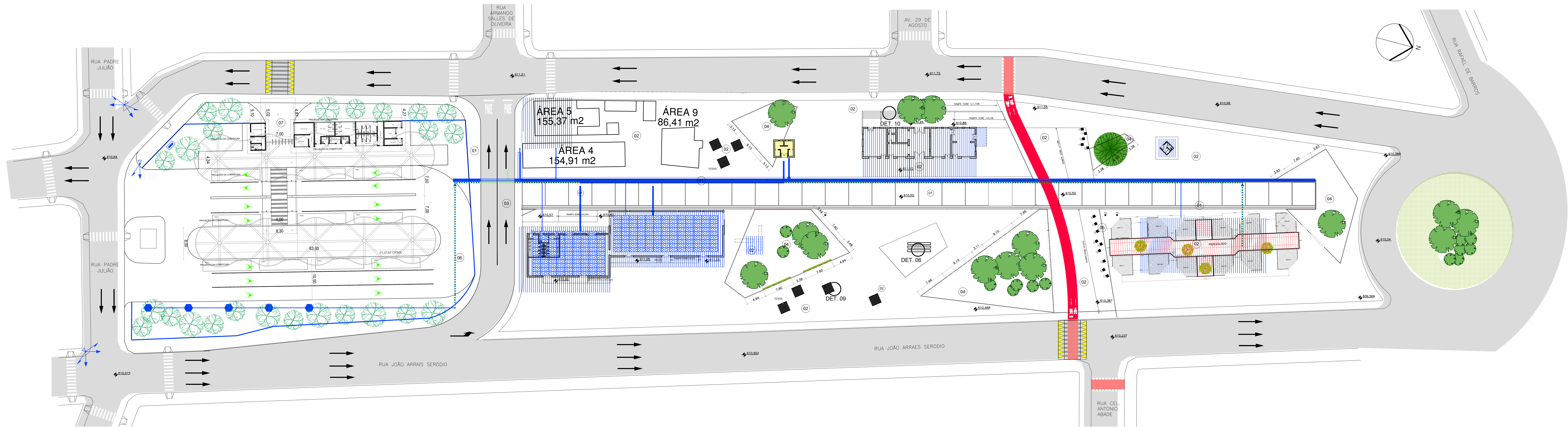
PLANTA INFRAESTRUTURA ELÉTRICA ESCALA 1:350
