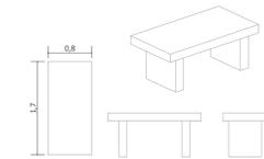
PONTO DE APOIO - DETALHE MESA EM CONCRETO
