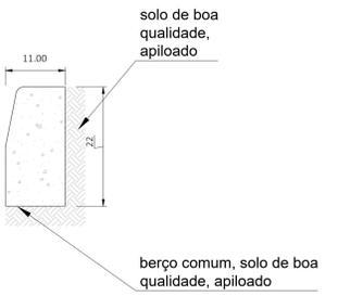
PISTA DE CAMINHADA - DETALHE SEÇÃO TRANSVERSAL DAS GUIAS SEM ESCALA
