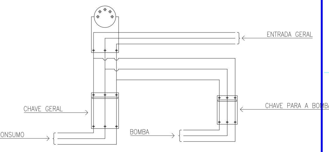
A CHAVE ELÉTRICA DE ALIMENTAÇÃO DA BOMBA DE INCÊNDIO SERÁ SINALIZADA COM A INSCRIÇÃO: "ALIMENTAÇÃO DA BOMBA DE INCÊNDIO — NÃO DESLIGUE".
