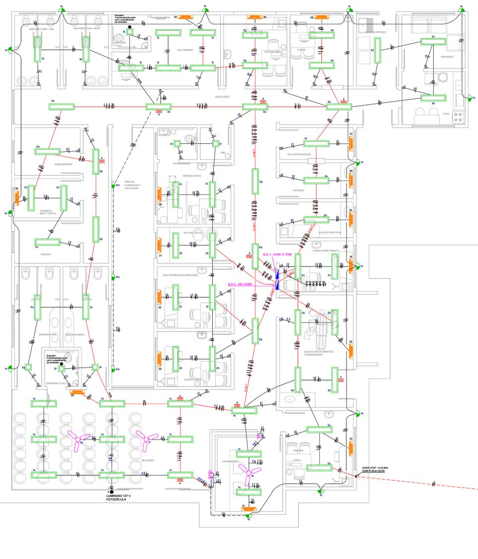
PLANTA BAIXA ILUMINAÇÃO | AR CONDICIONADO | VENTILADORES ESCALA 1:50
