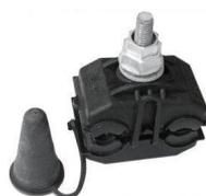
Finalidade: projetado para conexões de derivação por perfuração do isolante em redes e ramais aéreos de baixa tensão até 1kV. Aplicação: Condutores isolados de alumínio e/ou cobre com isolações em XLPE / PE (0,6 / 1 kV) e/ou PVC (750V). Material: Polímero, Elastômero e Cobre Eletrolítico. Modelos considerados: condutor principal: 16-120 mm<sup>2</sup> - condutor derivação: 4-35 mm<sup>2</sup>.
