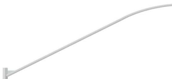
Braço reto para instalação de luminárias públicas, em aço galvanizado e zincado por imersão a quente. Tipo reto com sapata reforçada em chapa de aço para fixação. Diâmetro de 25 mm, comprimento do tubo de 3000 mm e parede do tubo de 1,5 mm; sendo que pequenas variações dimensionais são toleradas. Ângulo de inclinação de 10° a 20°. Fixação por meio de parafusos ou chumbadores, conforme o tipo de poste ou local a ser instalado.
