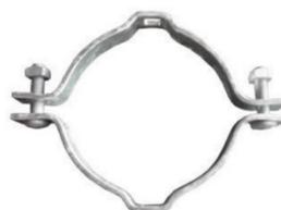
O item remunera o fornecimento de braçadeira circular em aço carbono SAE 1010 / 1020 galvanizado a fogo com 38 mm de largura, espessura de 1/4'' e comprimentos variáveis desde 140 mm até 300 mm, inclusive parafusos para fixação, referências 400 111 até 400 127 da Romagnole, ou equivalente e a mão-de-obra necessária para a instalação da braçadeira em postes circulares.
