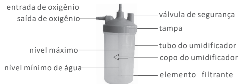
Figura 4: componentes do umidificador
