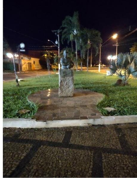
Para este local indica-se a instalação de um projetor LED de solo na cor azul na parte traseira do monumento e 2 projetores LED de Solo na cor branca de 5000K direcionados para a parte da frente, devendo ser instalados nas laterais do calçamento de acesso (pontos quadrados no solo).
