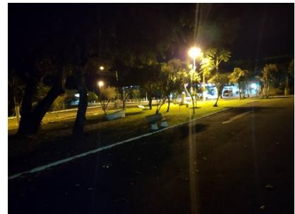
Para este local indica-se a substituição por luminárias LED na cor branca com 5000 K de temperatura de cor.
