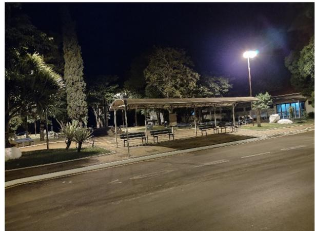
Indica-se a substituição do atual sistema de iluminação por luminárias de LED brancas de 5000K com atendimento médio mínimo de 20 lux.
