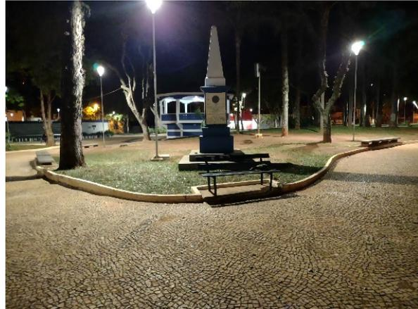
Para este local indica-se a aplicação de iluminação LED RGB no entorno do monumento, formada por 4 luminárias, a caixa de comando programável e proteção deverá ser hermética. As luminárias deverão ser fixadas no solo com caixas de proteção anti vandalismo.
