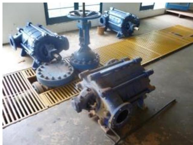
Foto 4.4 – Três das Cinco Bombas Reservas para os Conjuntos em Operação
